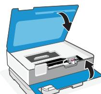
4. Wenn Sie fertig sind, schließen Sie die Zugangsklappe zu den Patronen und die vordere Klappe.
