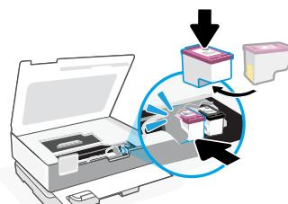
3. Draai de cartridges zodat het lange uiteinde naar de printer is gericht. Plaats de cartridges en klik deze vast.
