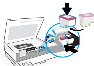
3. Drehen Sie die Patronen, sodass die größere Seite Richtung Drucker zeigt. Setzen Sie die Patronen ein und lassen Sie sie einrasten.
