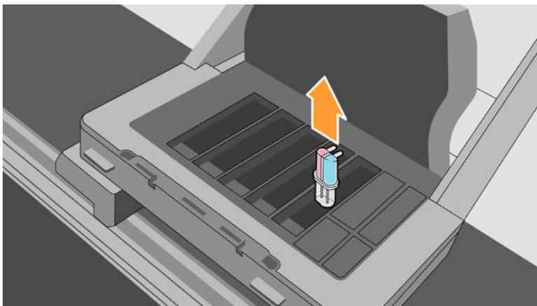
13. Inserte el cabezal de impresión universal incluido en este kit.
