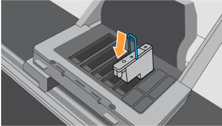
14. Cierre la tapa de los cabezales y la ventana. La impresora procederá a calibrar y alinear los cabezales de impresión.
