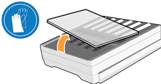
6. Setzen Sie die Wartungspatrone wie durch den Pfeil gezeigt in den Schacht ein. Schließen Sie nach dem Einsetzen in den Drucker die Klappe.
