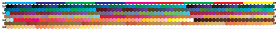
圖示 8-3 捲筒紙格式，藉由列印捲筒紙的完整寬度，將紙張用量降到最少
