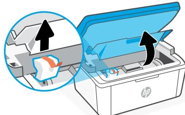
**SR** Uklonite sve trake i stiropor.**UK** Приберіть усі стрічки та пінопласт.**FR** Retirez toutes les bandes et la mousse.**PT** Remova todas as fitas e a espuma.
