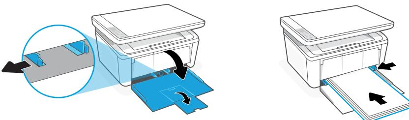
**SR** Otvorite ulazno ležište i izvucite vodice. Ubacite Letter ili A4 papir i podesite vodice.
