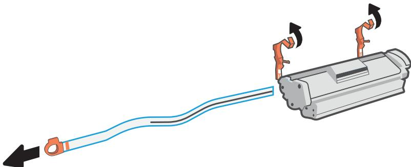
**SR** Uklonite narandžaste vodiče, trake i povucite jezičak da biste uklonili zaštitni film.**UK** Приберіть помаранчеві наклейки, стрічку та потягніть за язичок, щоб зняти захисну плівку.**FR** Retirez les guides oranges, la bande et tirez la languette pour retirer la pellicule de protection.**PT** Remova as guias cor de laranja, a fita e puxe a guia para remover o filme protetor.
