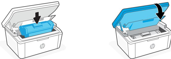
**SR** Ponovo ubacite kertridž i zatvorite vratanca.
