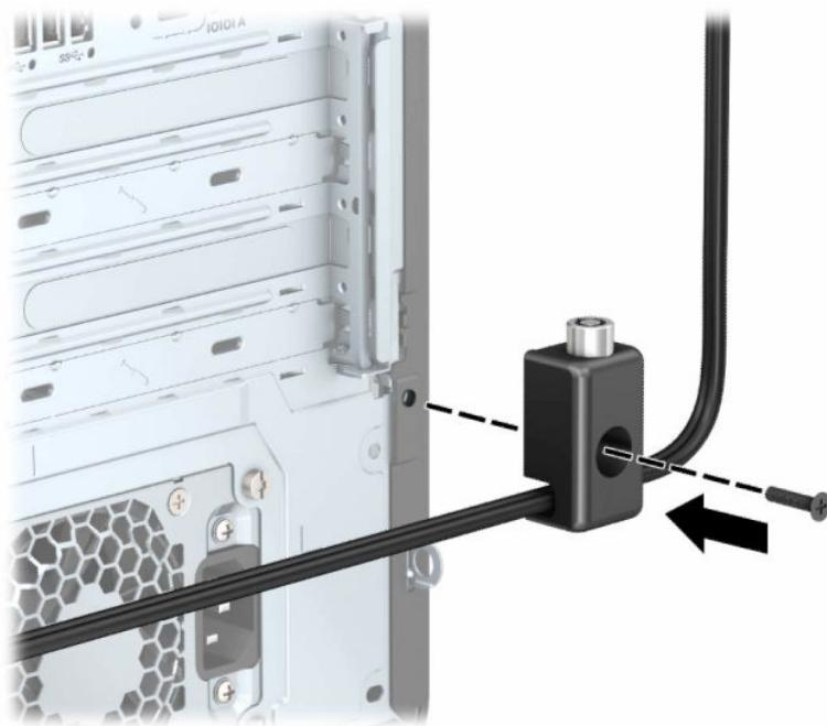
9. セキュリティロックケーブルの端の栓を差し込み（1）、ボタンを押し込んで（2）ロックを固定します。ロックの固定を外すには、付属の鍵を使用します。
