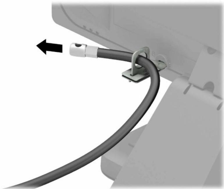
6. お使いの環境に適したネジを使用してオプションケーブルの固定具を机上に固定し（1）、オプションケーブルを固定具の中央に通します（2）。ネジは付属していません。
