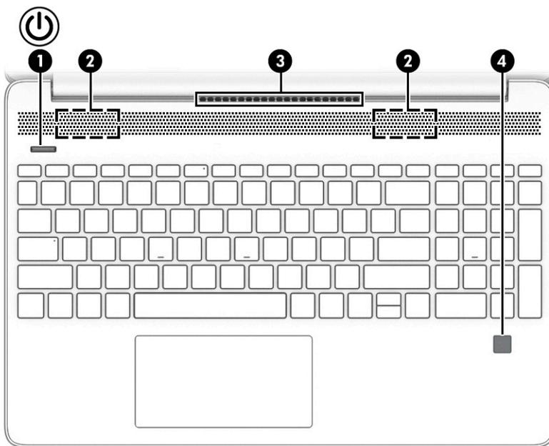
Os leitores de impressão digital, que permitem um login por impressão digital, podem estar localizados no touchpad, em um painel lateral do computador ou na tampa superior, abaixo do teclado.
