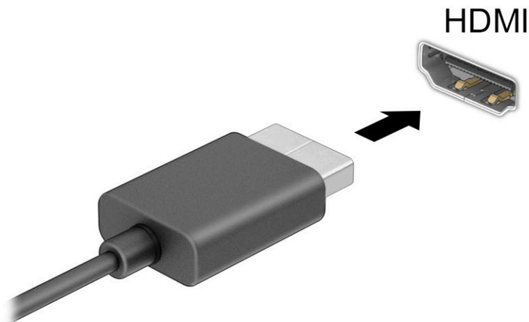
2. Conecte a outra extremidade do cabo ao monitor ou à TV de alta definição.
