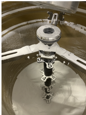
Figur 6-1 Numrene i den eksterne tank angiver materialeniveauet.
