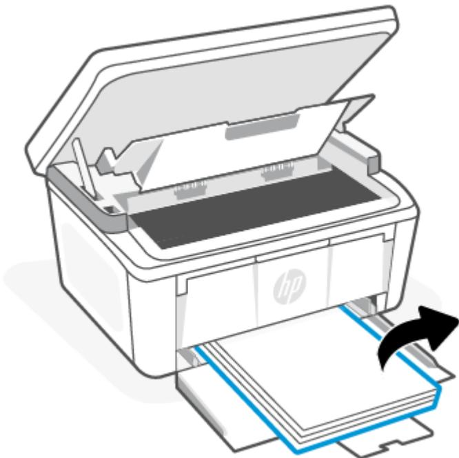
3. Med begge hender, ta tak i den siden av det fastkjørte mediet som er mest synlig (dette inkluderer midten), og trekk det forsiktig ut av produktet.
