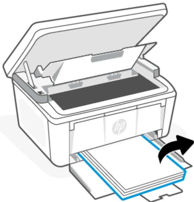
3. Возьмитесь двумя руками за наиболее выступающий край замятого материала (в том числе можно за середину) и аккуратно вытяните его из устройства.
