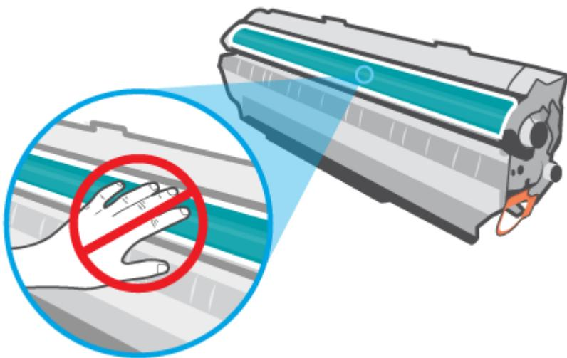
4. Возьмите картридж за оба края и осторожно покачайте его из стороны в сторону пять – шесть раз, чтобы добиться равномерного распределения тонера внутри картриджа.
