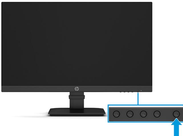
Cuando enciende el monitor por primera vez, aparece durante 5 segundos un mensaje de estado del monitor. El mensaje muestra qué entrada es la señal activa actual, el estado de la configuración de la fuente del conmutador automático (activado o desactivado; la configuración predeterminada es encendido), la resolución de pantalla predeterminada actual y la resolución de pantalla recomendada predeterminada.
