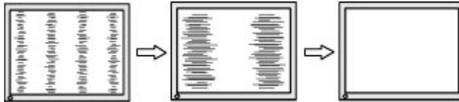
3. Después de ajustar el Reloj, si aparece parpadeo, borrosidad o barras en pantalla, continúe para ajustar la Fase.
