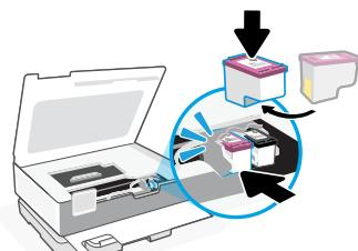
3. カートリッジを回転させて高い方がプリンター側を向くようにします。カチッと音がするようにカートリッジを挿入します。
