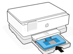
3. 用紙ガイドを広げます。レターまたは A4 用紙をセットします。用紙を完全にトレイに押し込み、ガイドを調整します。
