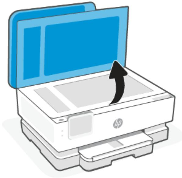
2. Legen Sie das Original mit der Druckseite nach unten auf das Scannerglas. Richten Sie es dabei an der Markierung hinten links am Glas aus.
