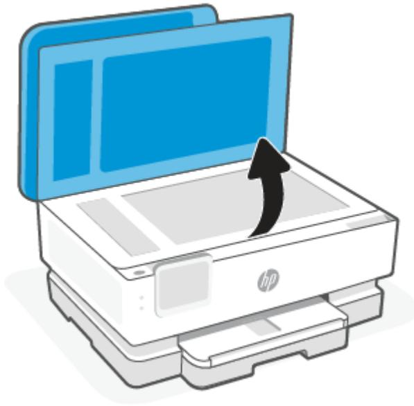
2. Reinigen Sie das Scannerglas und die Unterseite der Abdeckung mit einem sauberen, fusselfreien Tuch, das mit einem milden Glasreinigungsmittel angefeuchtet wurde.
