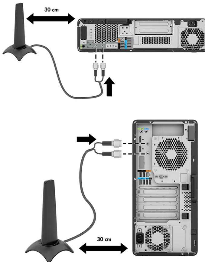
Para obtener el mejor rendimiento, coloque la antena a ambos lados del equipo donde tenga la línea de visión más clara del punto de acceso o el router. La distancia recomendada es de más de 30 cm con respecto al equipo. Evite colocar la antena delante, detrás o en la parte superior del equipo debido al riesgo de interferencia acústica.
