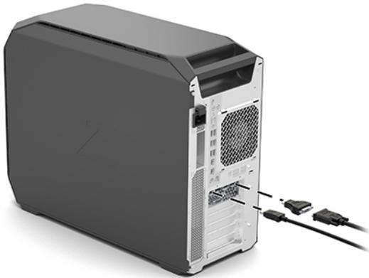
2. Conecte los otros extremos de los cables del monitor a los monitores.
