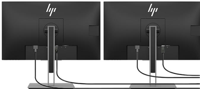
3. Conecte uno de los extremos del cable de alimentación del monitor al monitor y el otro a un enchufe con toma eléctrica de CA.
