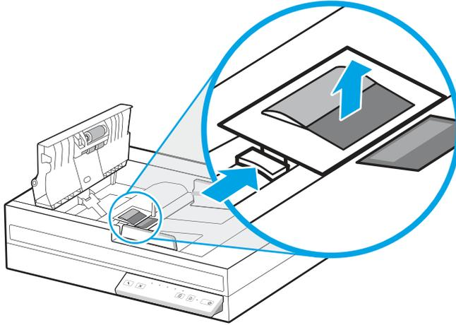
그림 3-2 분리 롤러 제거(N4600 fnw1 및 N6600 fnw1 모델)
