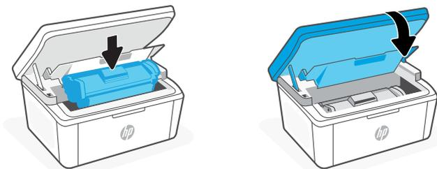
**EN** Reinsert the cartridge and close the door. **KO** 카트리지를 다시 넣고 덮개를 닫습니다.
