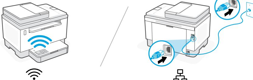
**PT** Para configuração sem fio, não conecte um cabo Ethernet. (somente modelos sem fio)
