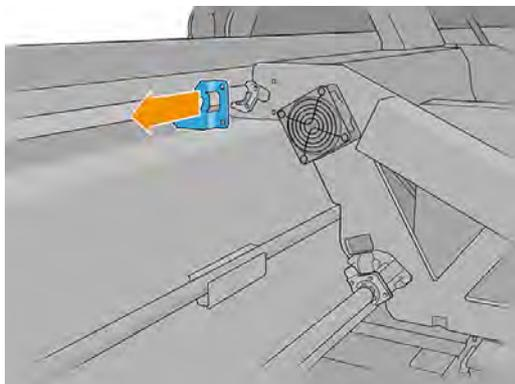
19. 將要更換的油氈往遠離托架的方向移動幾公釐，然後將其從掃描軸桿上拉出 (將其順時針或逆時針轉動將有所幫助)。將已使用/髒污的油氈當做廢棄材料丟棄。
