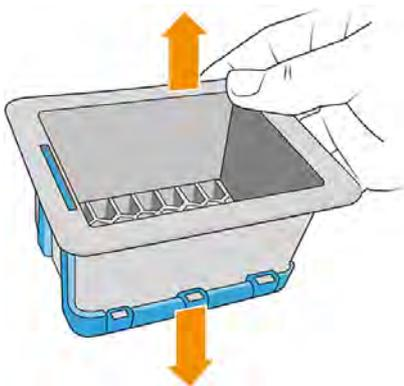
4. 使用軟毛刷和溫肥皂水，清潔濾網內側和外側。請務必充分清洗後，再將其放回到印表機中。您可以使用自來水清潔和清洗過濾器。
