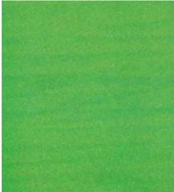
當墨水噴射時，托架底下會產生可以影響墨滴位置的空氣亂流。因此會形成一些墨水波紋並沈積在紙材上，產生了這樣的效果。
