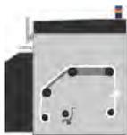
紙材移動的路徑是從進紙捲軸，依序經過主滾筒、壓板、前分紙器，最後到達出紙捲軸。
