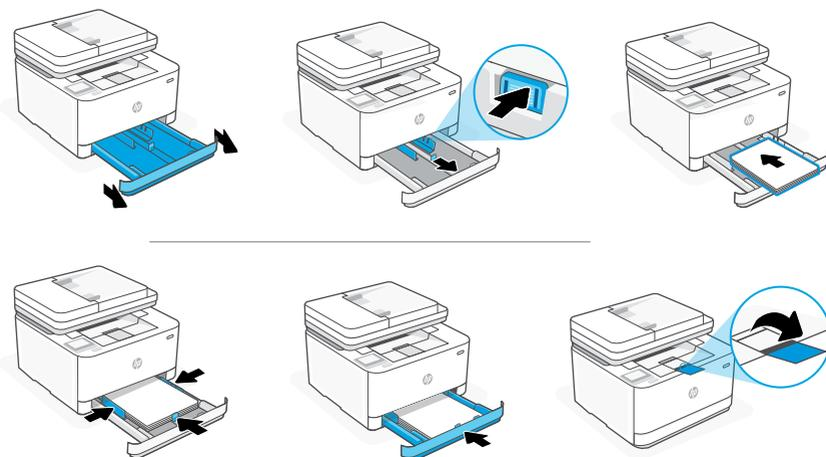
**EL** Τοποθετήστε χαρτί και ρυθμίστε τους οδηγούς.
