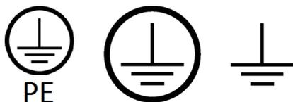
為合格電工識別保護接地 (PE) 端子，並僅限維護/維修人員用於連接端子。必須先接地，才可連接電源。
