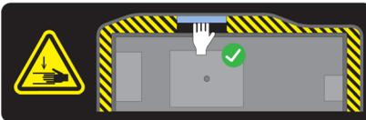
Danger d'écrasement. Maintenez vos mains à l'écart du bord du capot supérieur. Ouvrez et fermez le capot supérieur à l'aide de la poignée (en bleu) uniquement.
