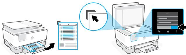
**NL** Gebruik het bedieningspaneel om de uitlijningspagina af te drukken en te scannen.
