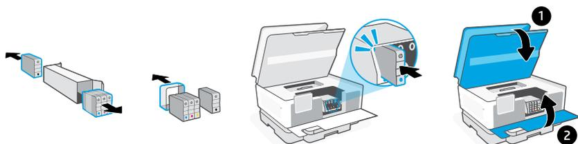
**NL** Open de voorklep en til de toegangsklep voor de cartridges bij de scannerklep omhoog. Haal de cartridges uit de verpakking. Plaats elke cartridge stevig in de aangegeven houder. Sluit beide kleppen.
