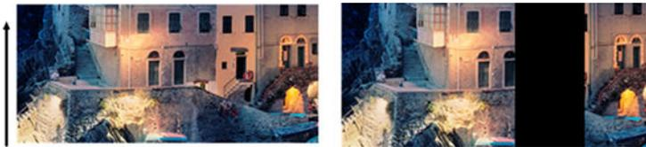
Escaneo de original afectado por el fallo de una barra de escaneo
