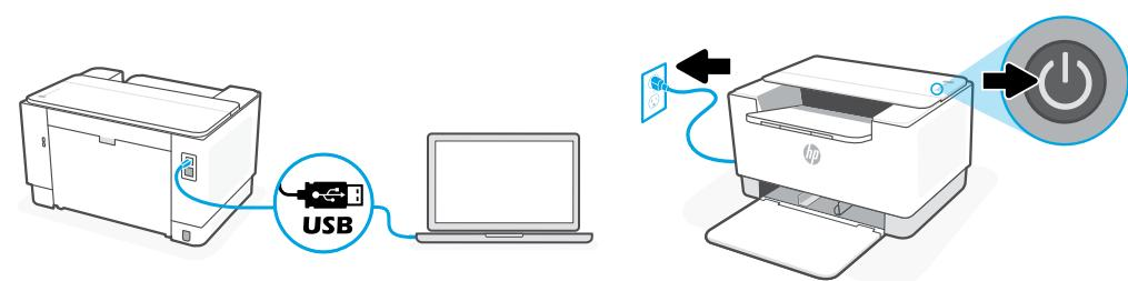
**EN** Connect the printer to a computer using a USB cable. Plug in and turn on the printer.**FR** Connectez l'imprimante à l'ordinateur à l'aide d'un câble USB. Branchez et allumez l'imprimante.**ES** Conecte la impresora a un equipo empleando un cable USB. Enchufe y encienda la impresora.
