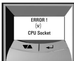
Vérifiez que le processeur est inséré dans le logement CPU.
