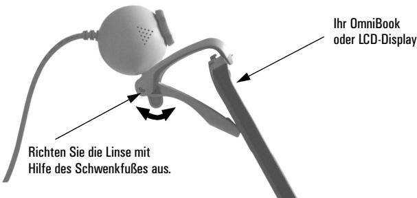
Bei Verwendung Ihrer USB-Kamera mit dem Standfuß stellen Sie diese auf den Monitor. Dabei muss das Logitech Logo an der Kamera in Ihre Richtung zeigen (siehe folgende Abbildung). Richten Sie die Linse durch Schwenken des Kameraauges nach oben bzw. unten aus, bis das Bild im Fenster "Logitech QuickCam Test" Ihren Wünschen entspricht.
