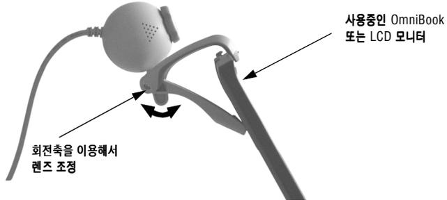
USB 카메라에 카메라 베이스가 있는 경우, 카메라 받침대의 Logitech 로고가 앞으로 오도록 모니터 위에 설치합니다 (아래 그림 참조). Logitech QuickCam Test 창의 화면에 원하는 영상이 표시되도록, 카메라를 위 아래로 기울여서 렌즈의 위치를 조정합니다.
