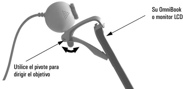
Si está utilizando la cámara USB con la base de cámara, sitúela sobre el monitor con el logotipo de Logitech que aparece en el soporte de la cámara orientado hacia usted (consulte la figura siguiente). Dirija el objetivo inclinando el ojo de la cámara hacia arriba o hacia abajo hasta que la imagen de la ventana QuickCam Test de Logitech sea satisfactoria.
