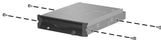
圖示 2-27 將導引螺絲安裝到軟碟機
