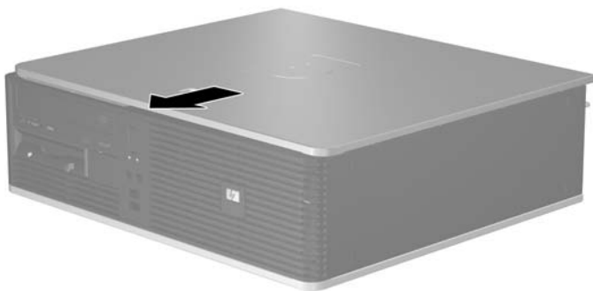
圖示 2-3 裝回電腦存取面板
