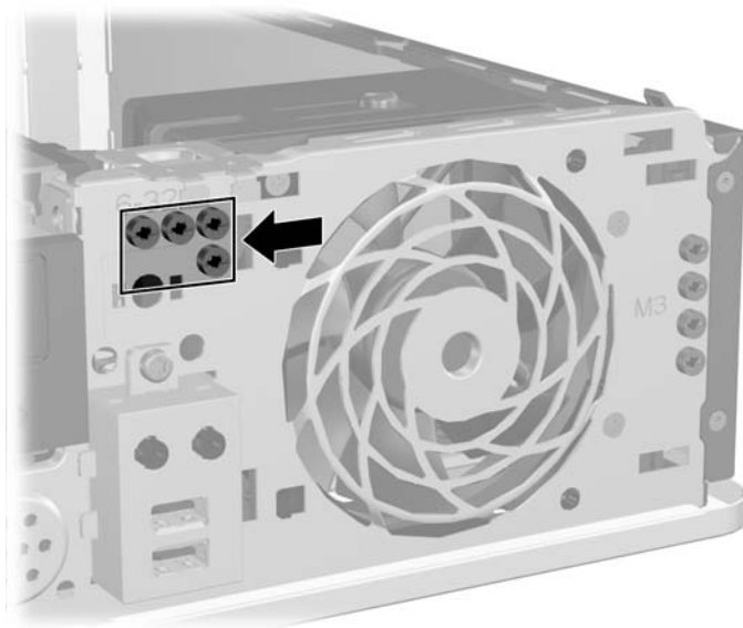
Figura 2-19 Localização dos Parafusos-guia 6-32 da Unidade de Disco Rígido Secundária
