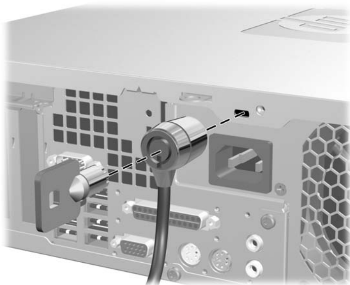
Figura C-1 Instalação da trava do cabo
