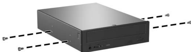
Figura 2-26 Instalação dos parafusos-guia na unidade óptica
