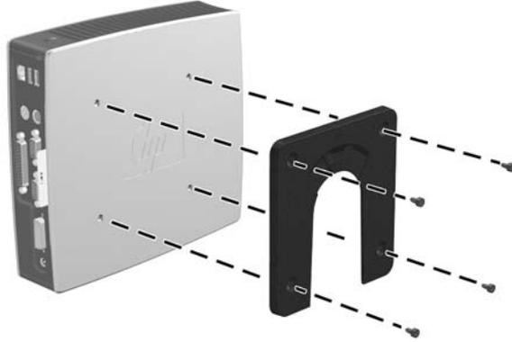
2. 使用安装设备工具包中的四个螺钉将 HP 快速释放托板的另一侧连接到您要安装瘦客户机的设备。确保释放杆朝上。
