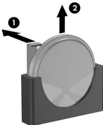
3. 将电池一端滑入插槽，并向下按电池直到导板卡住电池的边缘。
