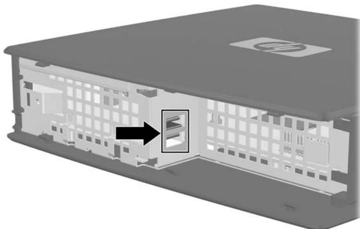
如果您在 USB 保护盒中安装 USB 鼠标和 USB 键盘，请使用 U 形钉理顺线缆的路线，并将其穿出线缆路由保护插槽，如下图所示。
