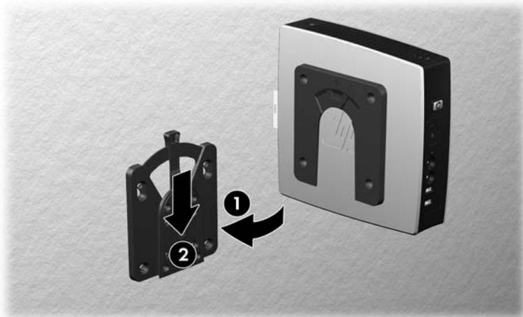
**注：** 在连接时，HP 快速释放托板将自动锁定到位。您只需将释放杆推到一侧即可卸下瘦客户机。
