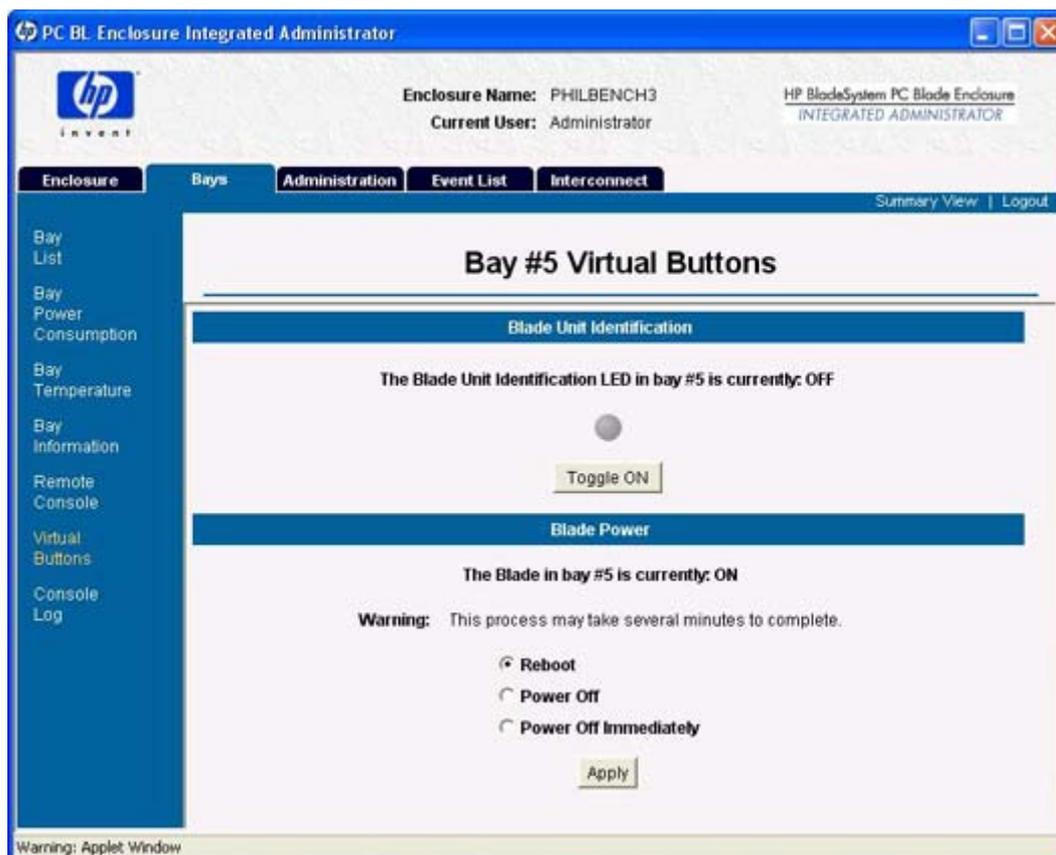
[Virtual Buttons]画面では、グループ管理者とエンクロージャ管理者が以下の機能を使用して Blade PC の再起動、電源切断、または確認を行うことができます。
