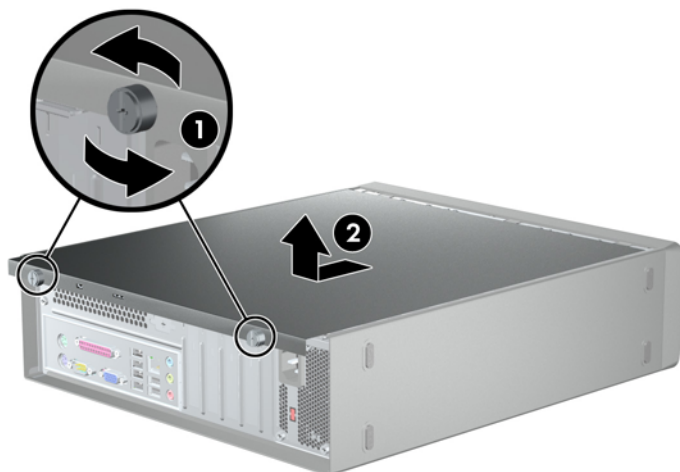
圖示 1 拆下存取面板
