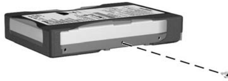
圖示 33 將導引螺絲鎖入硬碟
