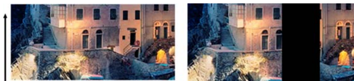
Oryginał i skan z uszkodzonym modułem CIS
