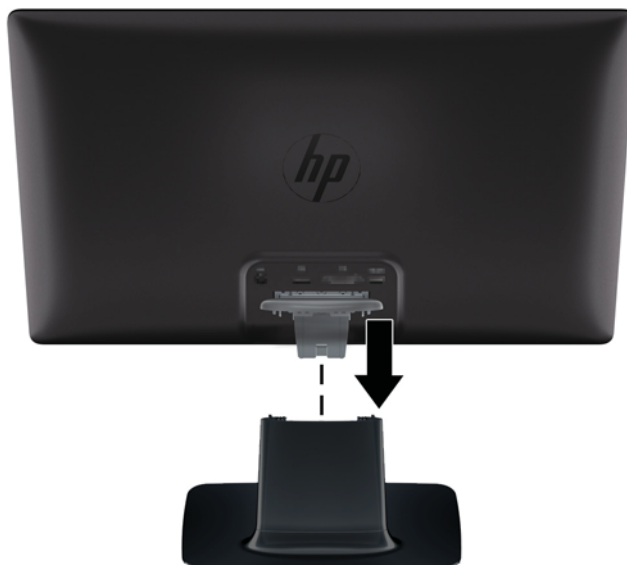
Figure 3-2 Insertion du panneau du moniteur
