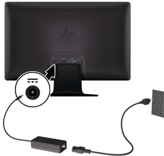
Figure 3-6 Branchement du cordon d'alimentation
