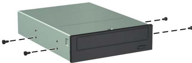
Рисунок 2-20 Установка оптического дисковода
