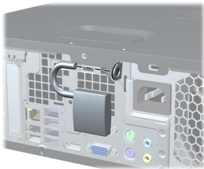
Рисунок 3-41 Установка навесного замка
