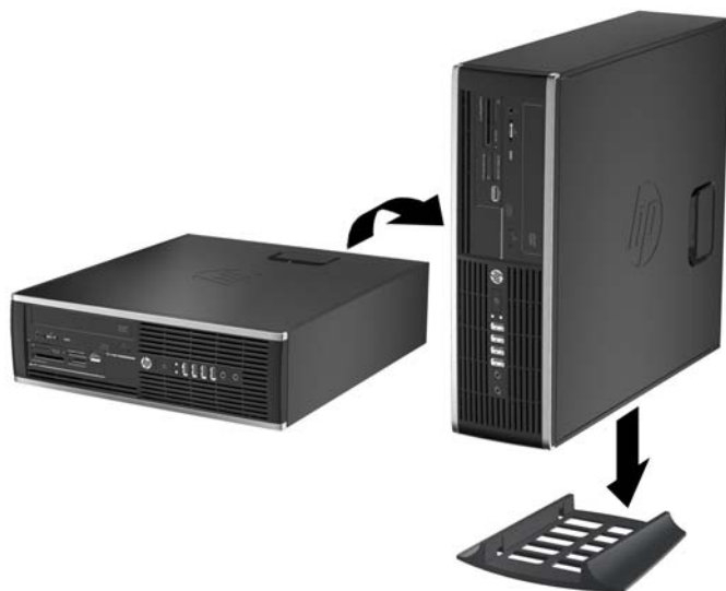
Рисунок 3-6 Изменение горизонтальной ориентации на вертикальную
