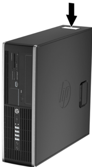
Рисунок 1-9 Расположение серийного номера и идентификационного номера продукта на модели с уменьшенным корпусом
