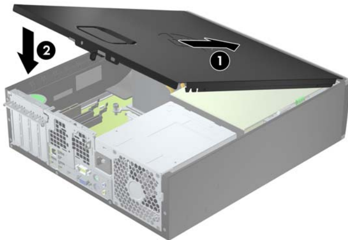
Рисунок 3-2 Установка защитной панели компьютера
