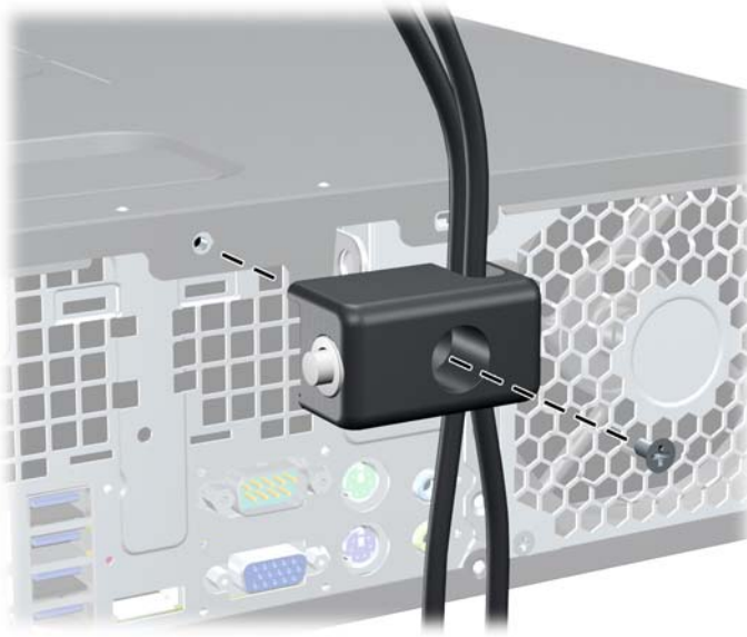
Рисунок 3-47 Закрепление замка на корпусе
