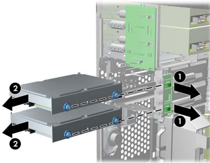
Рисунок 2-25 Извлечение жесткого диска
