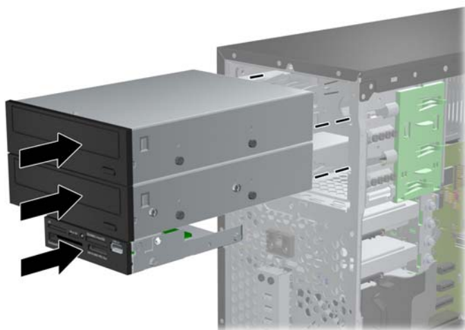
Рисунок 2-21 Установка запоминающего устройства в отсек
