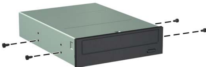
Рисунок 3-22 Установка направляющих винтов оптического дисковода
