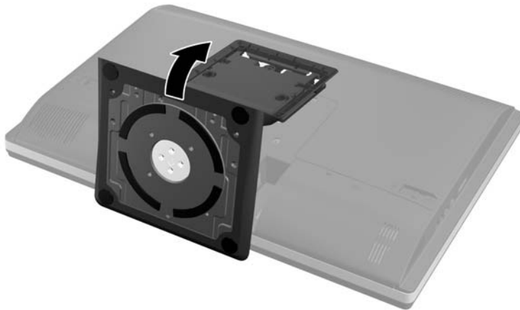
Figura 2-13 Rimozione del supporto
