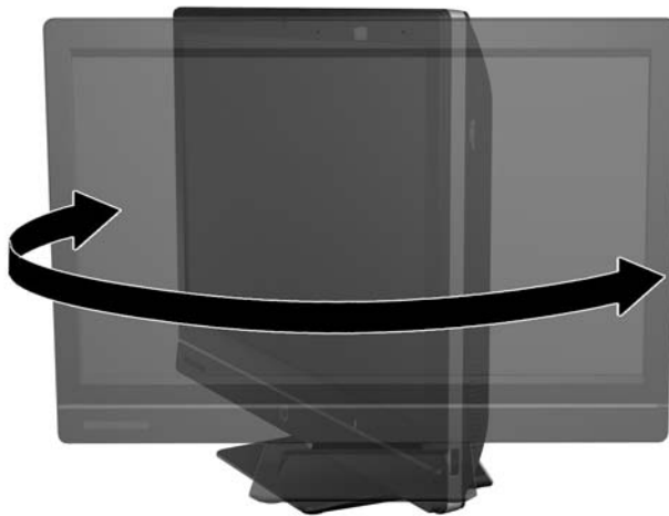
Figura 1-7 Regolazione della rotazione
