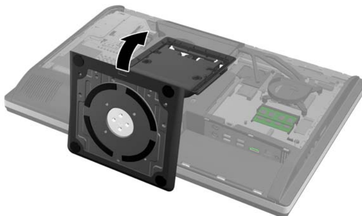
Figura 2-38 Rimozione del supporto
