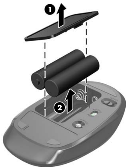
Figura 2-10 Rimozione delle batterie dal mouse senza fili
