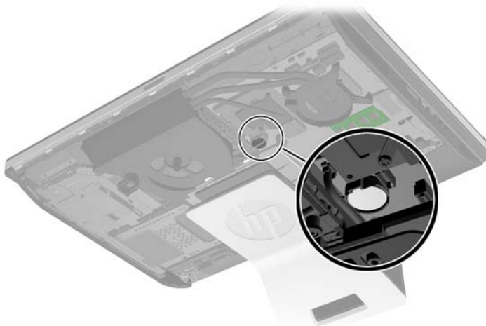
Figura 2-24 Individuazione della batteria
