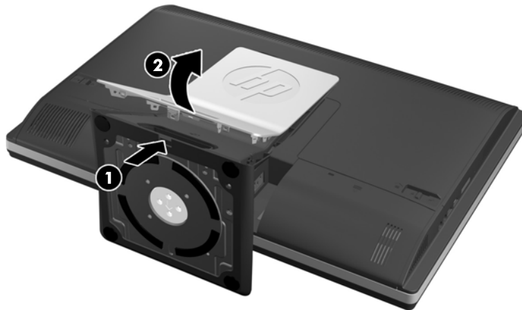
Figura 2-11 Rimozione del retro dal supporto
