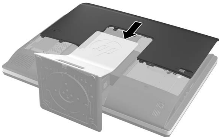
Figura 2-26 Riposizionamento del pannello di accesso
