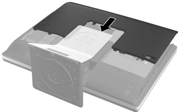
Figura 2-59 Riposizionamento del pannello di accesso
