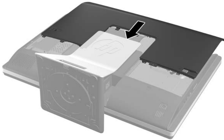
Figura 2-22 Riposizionamento del pannello di accesso
