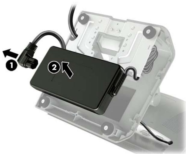
8. 将新电源的固定电源线穿过基座中心的孔，然后连接到背面板的直流电源接口。将新电源放入基座 (2)，然后将交流电源线连接到电源侧 (3)，并将电源线沿基座的护圈插槽布放。
