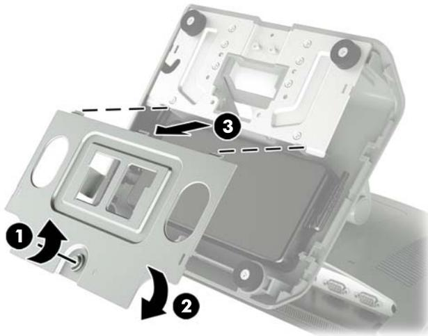
7. 拔下电源侧的交流电源线 (1)，然后向上提起电源使其脱离基座 (2)。
