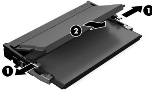
7. 要安装 SODIMM，请以大约 30° 的倾角将新的 SODIMM 滑进插槽 (1)，然后向下按 SODIMM 至插槽内 (2)，直至其锁定到位。
