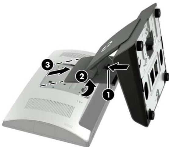
5. 要拆除紧凑型底座，将 RP9 面朝下放置在一个由柔软干净布料铺盖的平面上。将位于显示器头背面的释放锁定器 (1) 向上推，将底座向后倾斜 (2)，然后向上提起底座，使其脱离显示屏 (3)。
