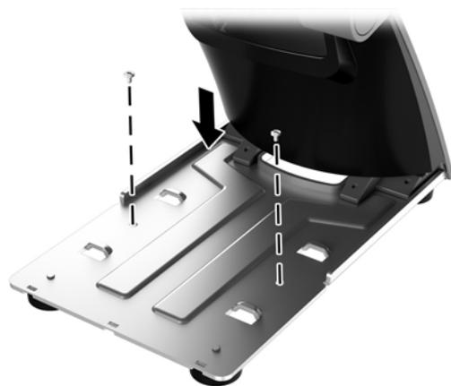
6. 将基座盖板插回紧凑型底座的基座 (1)，然后将颈部盖板扣入底座颈部 (2)。
