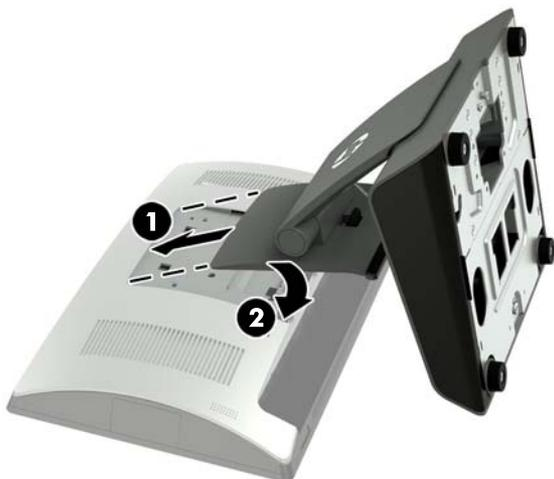
8. 要安装紧凑型底座，将 RP9 面朝下放置在一个由柔软干净布料铺盖的平面上。将支架底座顶部的卡舌滑入显示器头的插槽内 (1)，然后向下转动支架底座使其底部接触显示器头并卡好 (2)。
