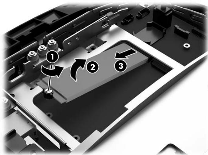
8. 要安装 M.2 存储设备，请以大约 30° 的倾角将存储设备上的针脚插入主板连接器 (1)。将设备另一端向下旋转 (2)，然后用之前拆下的或事先安装在螺孔内的螺钉固定设备 (3)。
