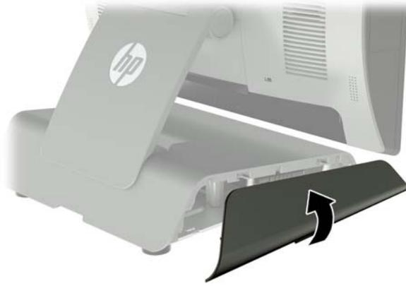
6. 将 RP9 面朝下放置在一个由柔软干净布料铺盖的平面上。提起拉片并拧松底座底部面板上的螺钉 (1)，然后提起面板底部 (2)，使其脱离底座 (3)。
