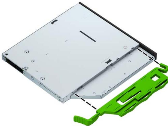
9. Schieben Sie das optische Laufwerk durch die Vorderseite des Gehäuses (1) vollständig in den Schacht hinein, bis es einrastet. Verbinden Sie dann das Stromkabel (2) und das Datenkabel (3) mit der Rückseite des Laufwerks.
