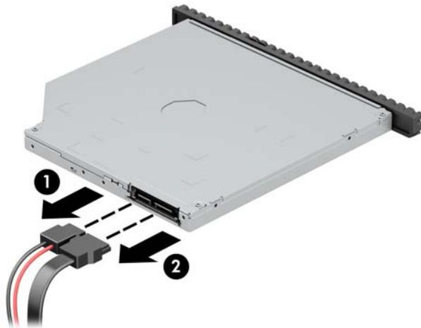
8. ドライブの背面右側にある緑色のリリースラッチをドライブの中央に向けて押し（1）、ドライブを前方向にスライドさせてベイから取り出します（2）。
