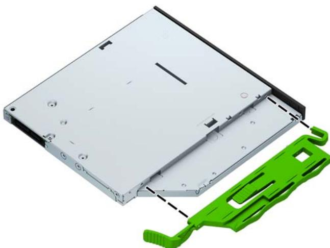
9. オプティカルドライブをフロントパネルを通してベイの奥までスライドさせ（1）、ドライブの背面にあるラッチ（2）を所定の位置に固定します。
